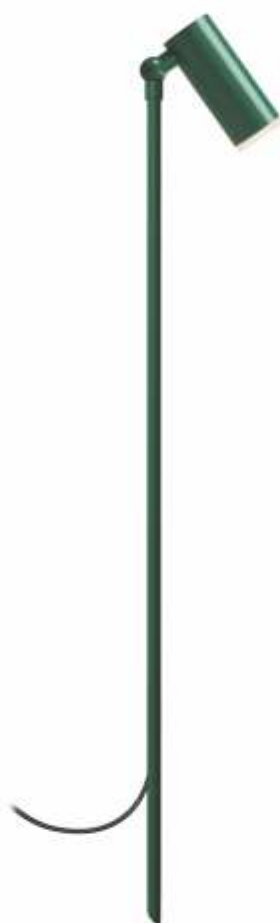
Balizador FIREFLY 1406 Sem base Porta lâmpada: 1 x GU10 MR11 Difusor: Acrílico Spot: Ø 38 x 100 mm Altura livre: 600 mm
