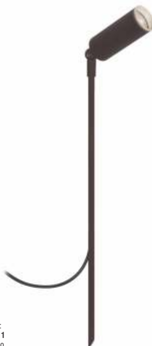
Espeto DIRECT 1439 Porta lâmpada: 1 x GU10 MR11 Difusor: Acrílico Spot: Ø 38 x 90 mm Altura livre: 600 mm
