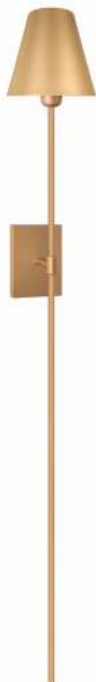
Arandela DINA METAL 1622 Porta lâmpada: 1 x E27 Cúpula em alumínio: Ø 175 x 165 mm Luminária: 195 x 175 x 1420 Base de parede: 110 x 15 x 150 mm
