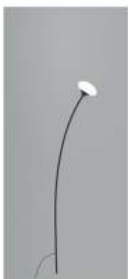
Balizador PAPOULA 1400 Sem base LED: 1 x 3W - 3000K 300 Lúmens - 127 V ou 220V Difusor: Globo amendoado de vidro branco opalino Ø 120 x 60 mm Luminária: Ø 120 x 70 mm Altura livre: 1200 mm
