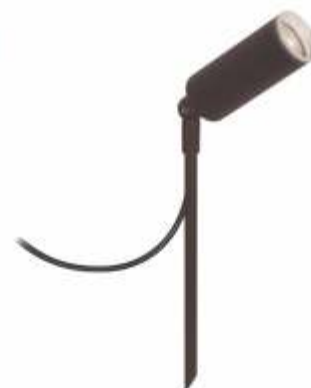
Espeto DIRECT 1100 Porta lâmpada: 1 x GU10 MR11 Difusor: Acrílico Spot: Ø 38 x 90 mm Altura livre: 150 mm
