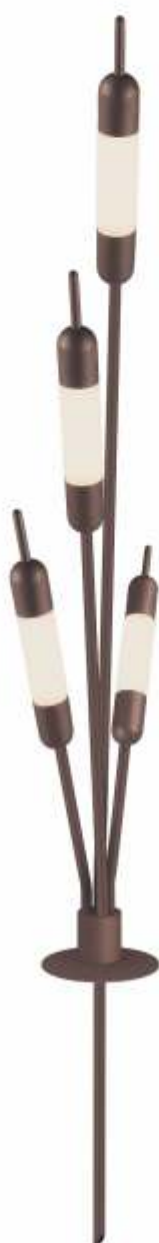
Balizador TABOA 4 1389 Com base Porta lâmpada: 4 x G9 Halopin Difusor: Acrílico fosco Luminária: Ø 200 x 800 mm Base: Ø 100 x 2 mm Altura livre: 800 mm
