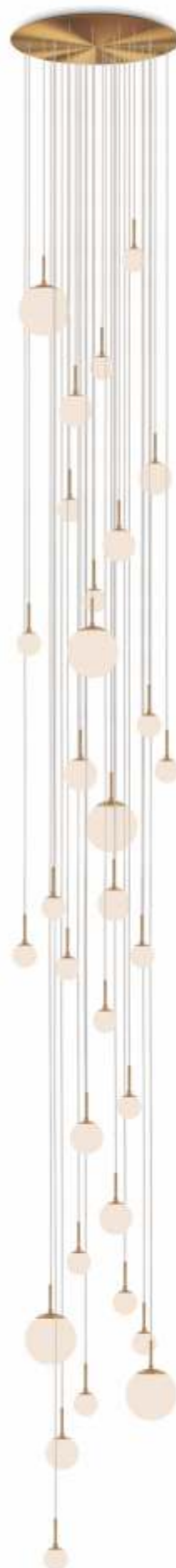
Pendente WASSERFALL 6M 1947 Porta lâmpada: 26 x G9 Halopin + 5 x E27 Difusores: Globos de vidro opalino branco 18 x Ø 100 mm 8 x Ø 140 mm 5 x Ø 200 mm Luminária: Ø 700 x 6000 mm Base de teto: Ø 700 x 20 mm Cabos de alimentação: 6 m (reguláveis)
