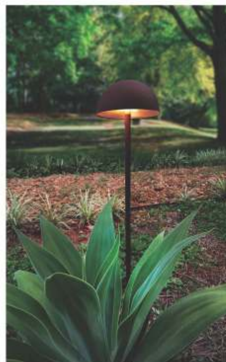
Balizador MUSHROOM 1383 Com base Porta lâmpada: 2 x G9 Halopin Difusor: Acrílico Luminária: Ø 140 x 70 mm Base: Ø 100 x 2 mm Altura livre: 800 mm
